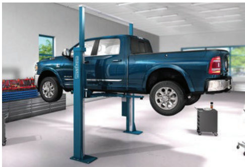
Der hier einknickte Otto-Arm erleichtert den Zugang zur Karosserie
