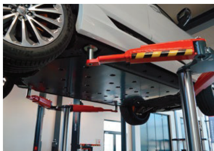
Bühne frei mit Masterlift: Der Akku des Audi e-tron bleibt zugänglich.
